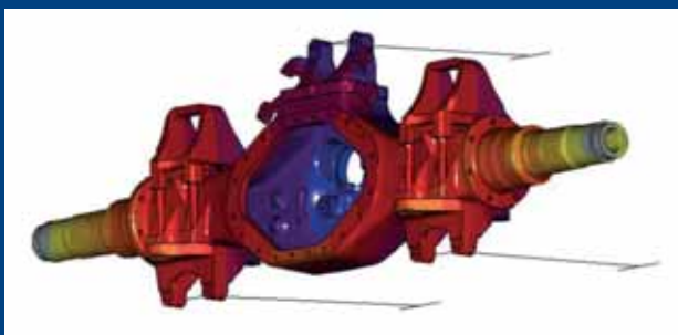
Deformace tělesa nápravy
