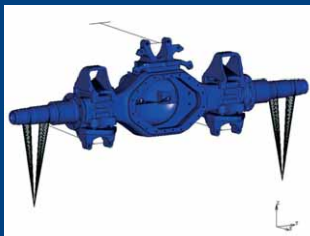
Geometrický a strukturální model nápravy
