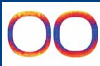
Rozložení napjatosti hlavního nosného průřezu tělesa před a po optimalizaci
